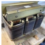
16963 Erea ATT 95000 transformer transformer 95kVA 3 x 240 V 238,7 A 50-60 Hz 3 x 400 V 137,3 A reversible.
