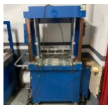
16601 Deal II máquina flejadora 2004 Flejado de doble unidad, mesa giratoria para hacer la cruz, programa electrónico Siemens Ancho del fleje: 5 - 9 mm Capacidad: con flejado simple hasta 35 paquetes por minuto, con flejado doble hasta 20 paquetes por minute
